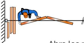
Abra los paneles y empuje sobre la cara del panel hasta ponerlos en posición sobre la línea del riel.
