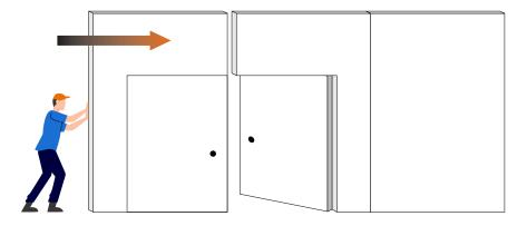
Active el mecanismo localizado en la cara del panel insertando la llave en el orificio y rótela media vuelta.
